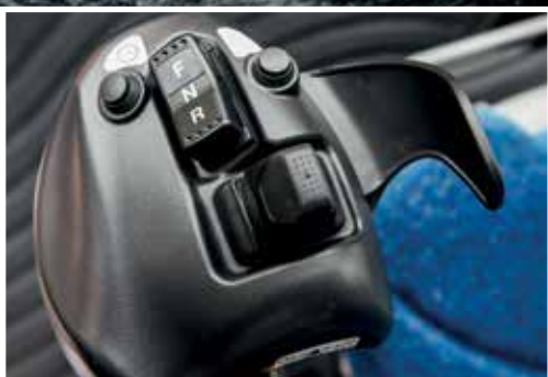
Styresystemet med joystick (tilleggsutstyr) gir eksepsjonell kontroll.
