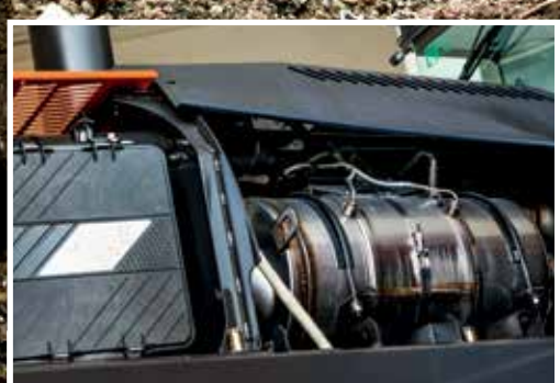
SCR-systemet reduserer utslipp og støy.
