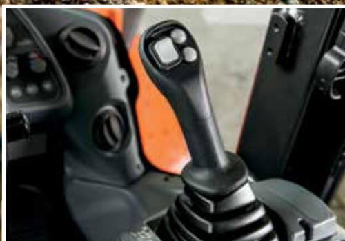
Quick power-bryteren gir deg mer kraft når det trengs.
