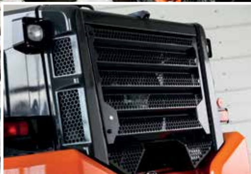
En ny bakre grill beskytter radiatorrommet.
