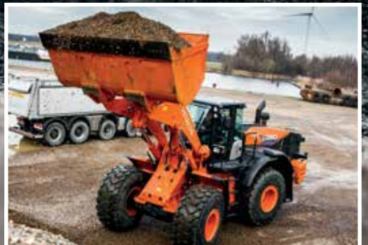
Styringssystemet for hydraulikken sikrer at lasteaggregatet beveger seg jevnt.
