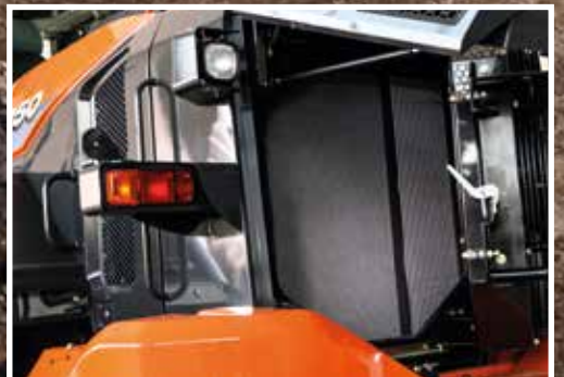
Tilstopningsfrie radiatorer (tilleggsutstyr) øker slitestyrken.
