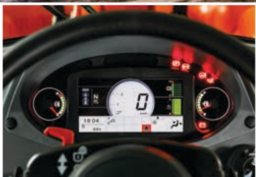
Ny LCD-skjerm viser maskinens status og innstillinger.
