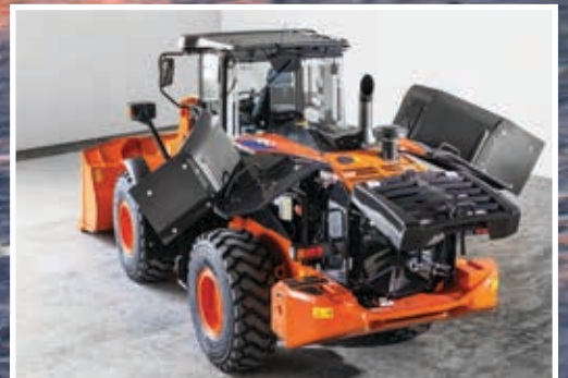
Enkel tilgang for vedlikehold fra bakkeplan.
