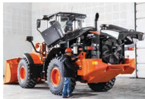
Enkel tilgang til motorrommet.
