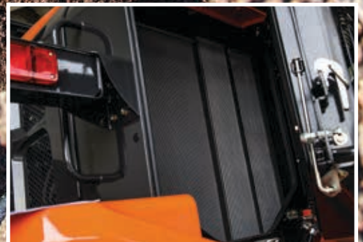
Tilstopningsfrie radiatorer (tilleggsutstyr) øker slitestyrken.
