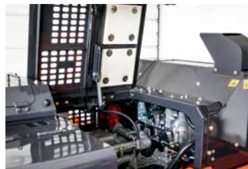
SCR-systemet reduserer utslipp og støy.
