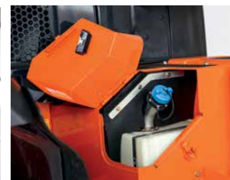
AdBlue tank lett tilgjengelig.
