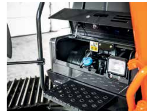
AdBlue tank lett tilgjengelig.
