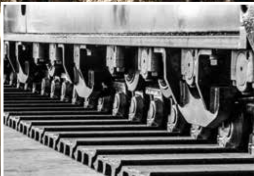
Flere beltestyringer gir beltededene bedre slitestyrke.
