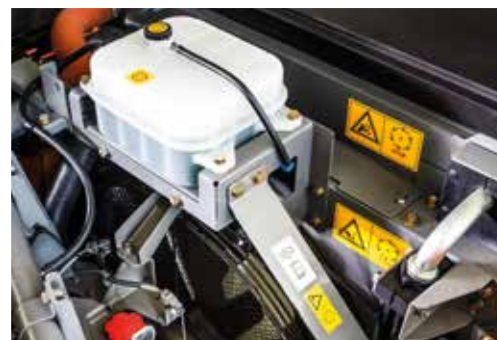
Ekspansjonstanken forhindrer at motordeler overopphetes.
