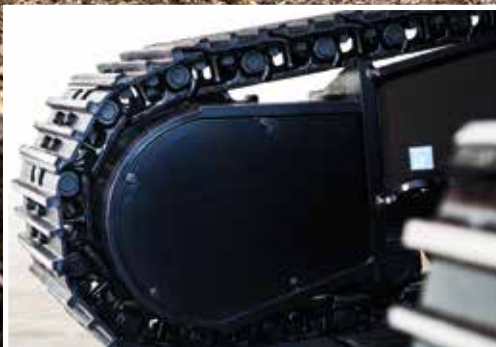
Tykkere deksel på beltemotoren gir bedre beskyttelse mot skader.
