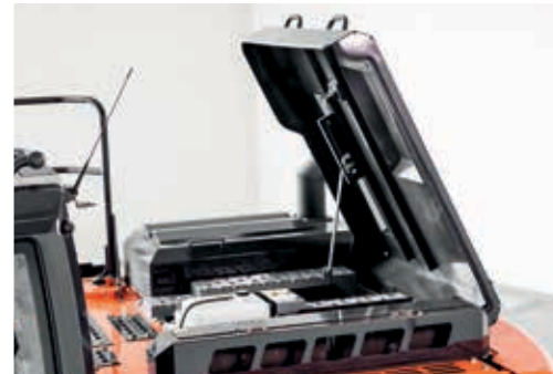
Lett tilgang til motorrommet.
