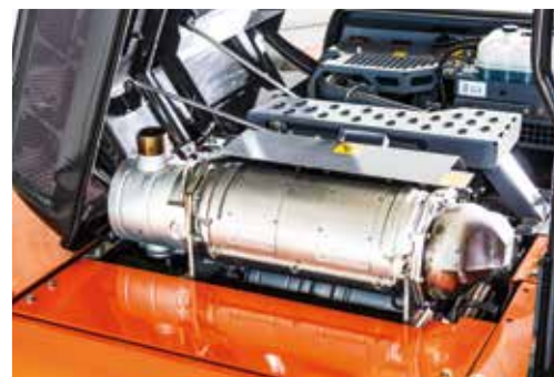
SCR-systemet reduserer utslipp og støy.
