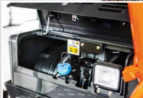
Urea sprøytes inn i eksosgassen for å redusere utslipp.
