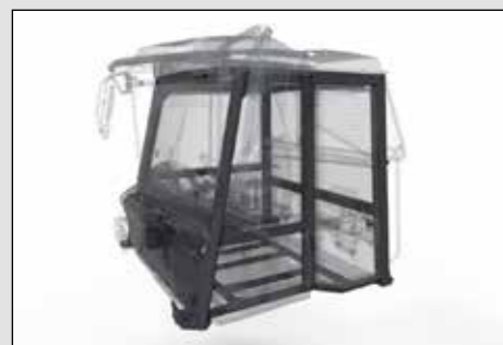
De støydempede førerhusene er ROPS-/FOPS-sertifiserte med luftdempede operatørseter. Både operatørsetet og opplæringssetet har rullebelter.
