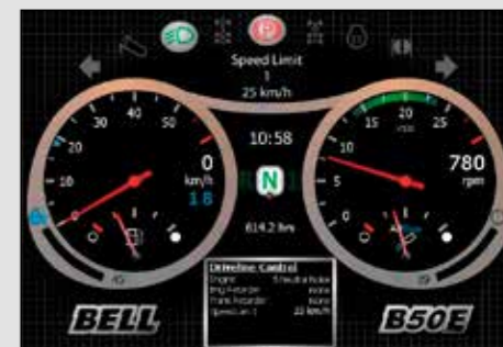
Kontroller for maksimal hastighet kan aktiveres både av operatøren og av forvalgte innstillinger for automatisk redusering av fart.
