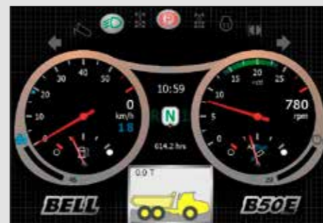
Det eksklusive alternativet for integrert lastevkt gir operatøren sanntidsinformasjon om nyttelasten mens maskinen lastes. Det kan også aktiveres en modus for hastighetsbegrensning hvis maskinen er betydelig overlastet.
