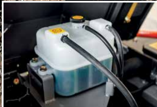
Ekspansjonstanken forhindrer at motordeler overoppheves.
