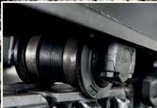
Styrket materiale i foringer gir bedre slitasjebestandighet.
