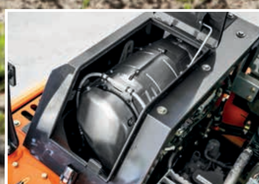
SCR-systemet reduserer utslipp og støy.
