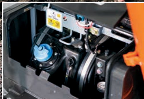
Urea sprøytes inn i eksosgassen for å redusere utslipp.
