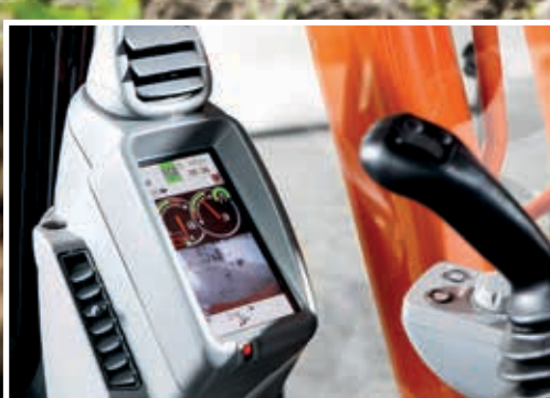
LCD-monitoren viser maskinens status og innstillinger.
