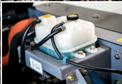
Ekspansjonstanken forhindrer at motordeler overoppheites.
