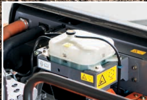
Ekspsjonstanken forhindrer at motordeler overoppheles.
