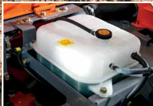
Ekspansjonstanken forhindrer at motordeler overoppheites.
