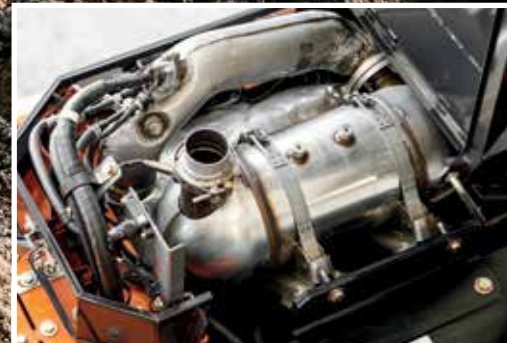
SCR-systemet reduserer utslipp og støy.
