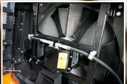
De slitesterke radiatorene er korrosjonsbestandige.
