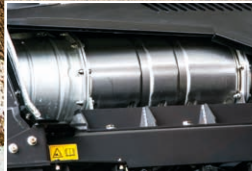
SCR-systemet reduserer utslipp og støy.
