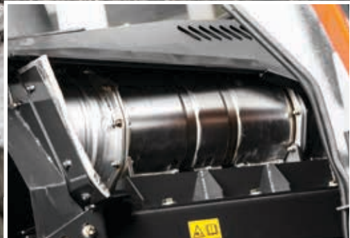
SCR-systemet reduserer utslipp og støy.
