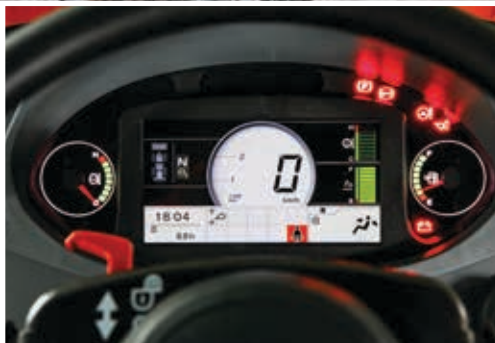
LCD-skjermen viser maskinens status og innstillinger.
