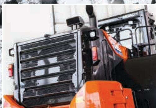
En ny bakre grill beskytter radiatorrommet.
