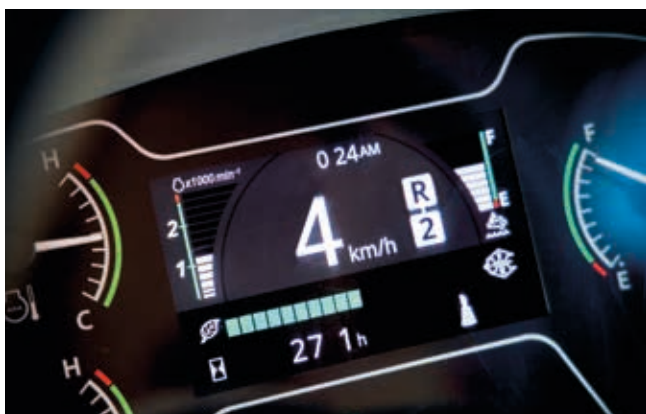
ECO-måleren bidrar til fokus på redusert drivstofforbruk.
