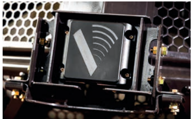
Ryggesensoren registrerer hindringer bak maskinene og gir økt sikkerhet på arbeidsplassen.
