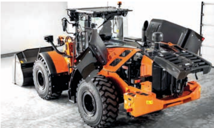
Motordekselet gir enkel tilgang for daglige inspeksjoner.
