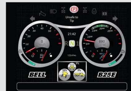
Med en integrert rullsensor i kjøretøyet forhindres betjening av lasteplanet hvis dumperen ikke er i en sikker posisjon.
