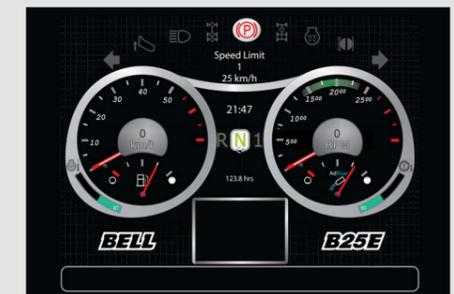
Kontroller for maksimal hastighet kan aktiveres både av operatøren og av forvalgte innstillinger for automatisk reduisering av fart samt bruk av retarderen for å hindre for høy fart på arbeidsstedet.
