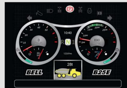
Det eksklusive alternativet for integrert lastevekt gir operatøren sanntidsinformasjon om nyttelasten mens maskinen lastes. Det kan også aktiveres en modus for hastighetsbegrensning hvis maskinen er betydelig overlastet.
