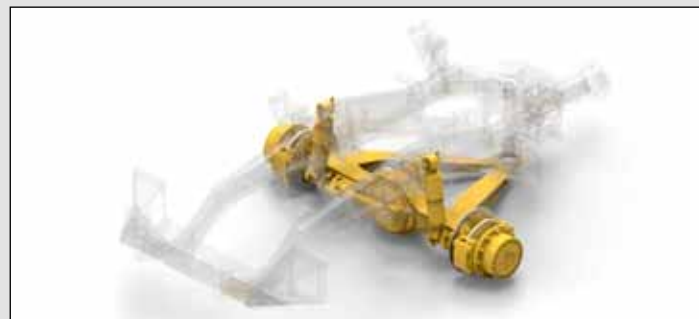
Støtdempere foran bidrar til å redusere vibrasjoner mens et førsteklasses luftdempet sete reduserer den rullende bevegelsen som ofte oppstår ved kjøring utenfor vei.
