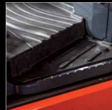
Praktisk stigtrinn Trinnene er plassert i en praktisk høyde så det blir enklere for operatørene å gå inn i førerhuset.
