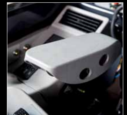
Justerbare armlener Selv lange arbeidsøkter er mindre slitsomme for operatøren takket være de justerbare armlenene.
