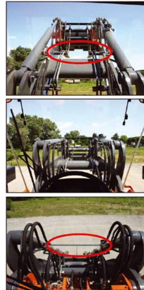
Bildet over: Utsikten fra førerhytten i parallelløfteren ved høy og lav lastearm. Selv høyt oppe ser man enden av pallegaffelen fra førerhuset.
