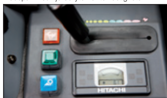
Bladspak med kjørebytter for to hastigheter.
