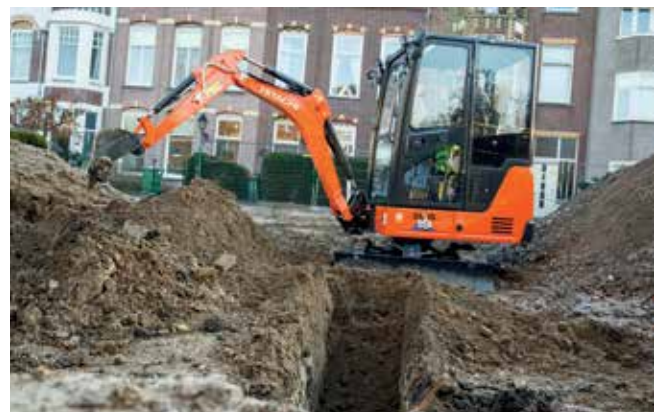
Bomsylinder øverst på bommen minimerer ståtiden takket være mindre kontakt med sylindren.
