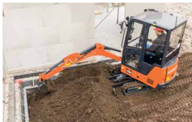
Den korte fremre minimums-svingradiusen er ideell for steder med begrenset plass.
