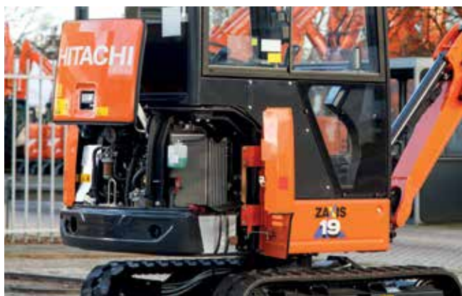
Motordekslet skyves åpent vertikalt, noe som er perfekt for steder med begrenset plass.
