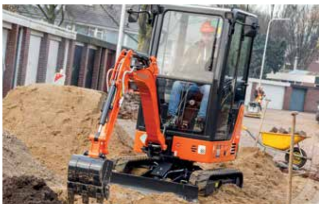
Hydraulikkslangen for fronttilbehøret er lagt inni bommen, slik at den er godt beskyttet.
