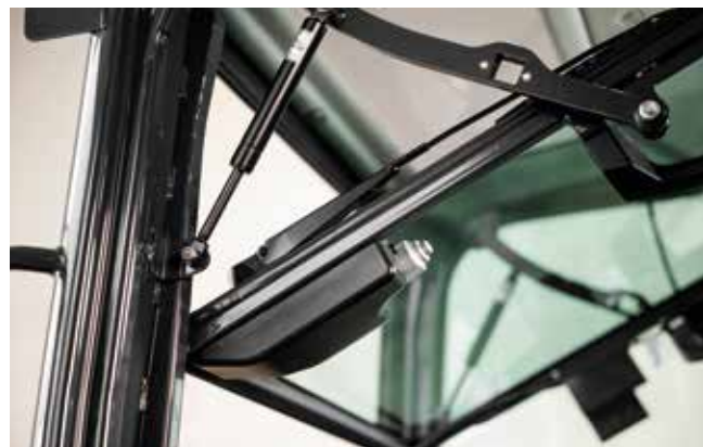
Frontruten med gassdempere åpnes enkelt og sikkert.
