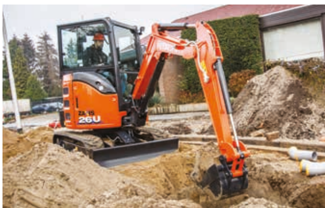
Maskinfronten er utstyrt med et bomsylindervern som øker slitestyrken.
