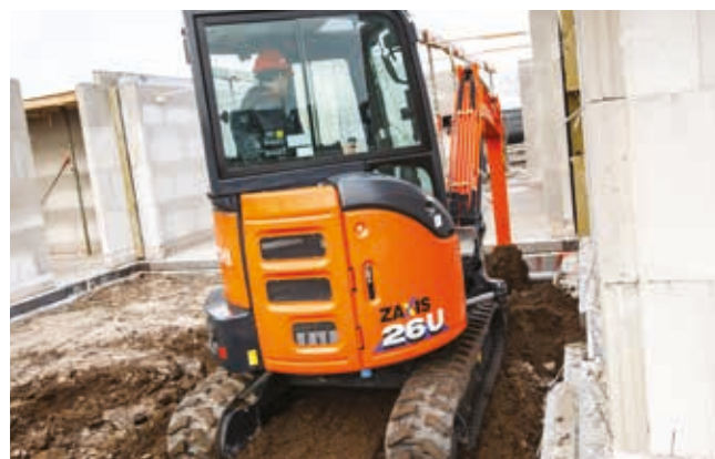
Kort bakre svingradius er ideelt for arbeid på steder med begrenset plass.
