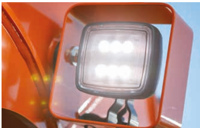
LED-lys har lengre levetid enn halogenlys.
