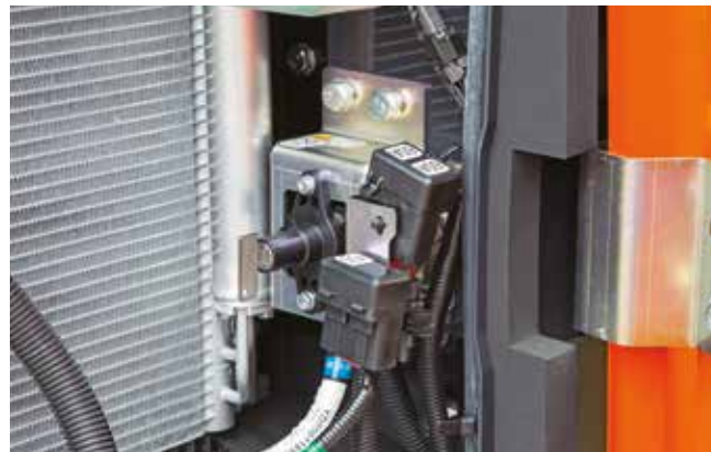
Hovedstrømbryteren gjør at vedlikeholdet kan utføres på en trygg måte.
