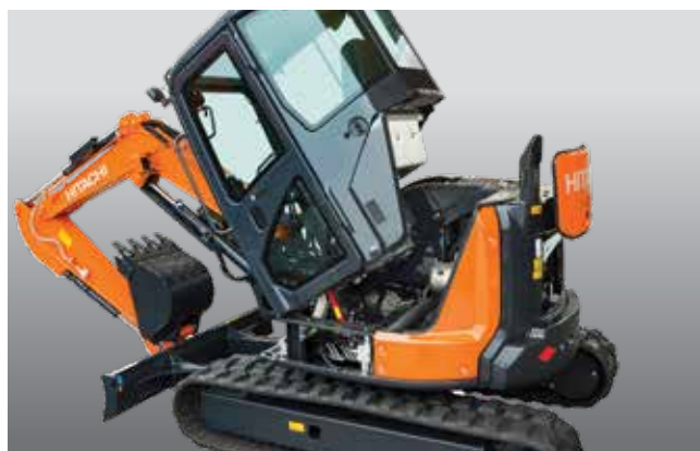
Den vipbare hytten gir enkel tilgang til motoren og reguleringsventilen.
