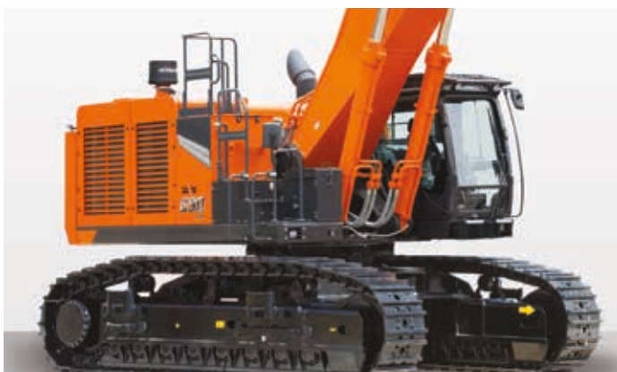
Et nytt trinn gjør tilgangen til overvognen enklere.
