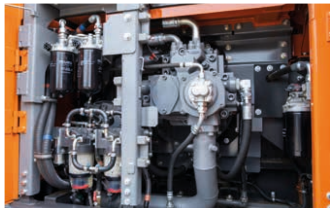
Med HIOS V-hydraulikksystemet oppnås det drivstoffbesparelse på opptil 22 %.
