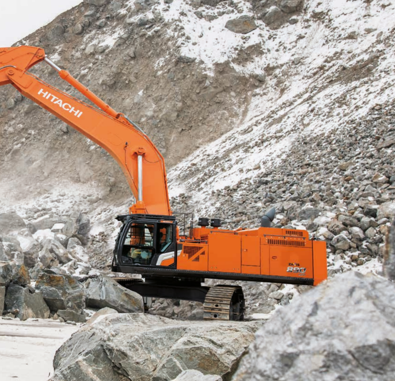
Det nye HIOS V-hydraulikkssystemet reduserer drivstofforbruket og fører til høyere produktivitet.
