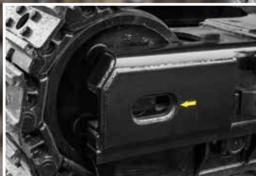
Forsterket motorbeskyttelse og ledehjulbrakett gir beskyttelse mot skader.
