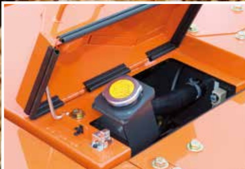
Ekspanjonstanken forhindrer at motordeler overoppheles.
