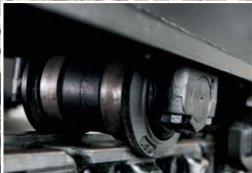
Ny design på underruller hindrer inntrengning av søle som forårsaker skader.
