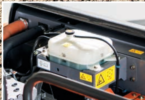
Ekspanjonstanken forhindrer at motordeler overoppheves.
