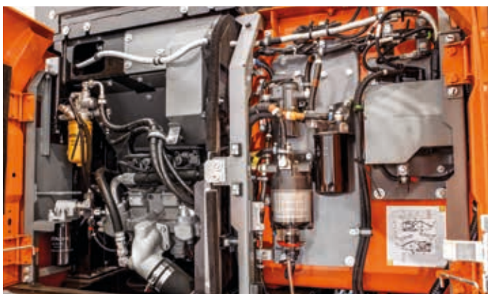
Filtrene er blitt omplassert for enklere tilgang.
