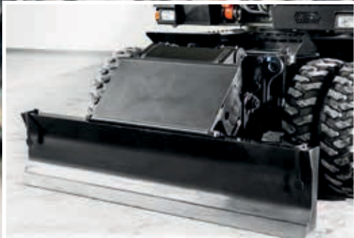
Et stort skjærsylinderdeksel gir bedre beskyttelse.
