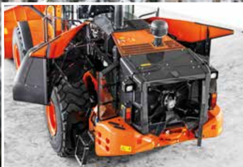
Dekslene kan åpnes helt og gir enkel tilgang for vedlikehold.
