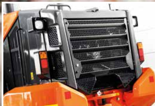
En ny bakre grill beskytter radiatorrommet.
