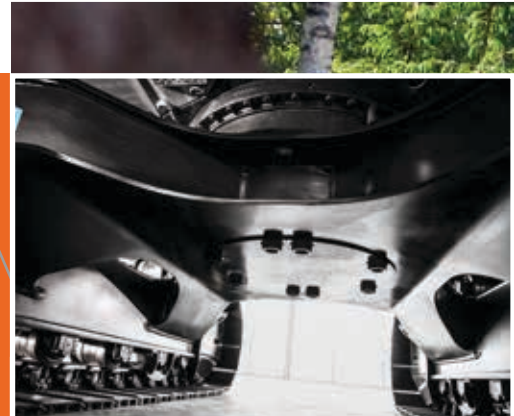
Svivelplaten er gjort mer slitesterk gjennom større tykkelse og en forsterket ribbekonstruksjon.
