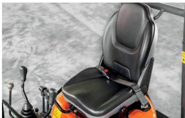
Sete med glidefunksjon, sikkerhetsbelte med ny plassering, motordekselhåndtak og justerbar rygg med stoppfunksjon.
