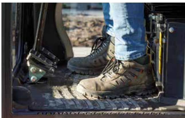
Innfellbare kjørepedaler kan brukes i stedet for håndspak.
