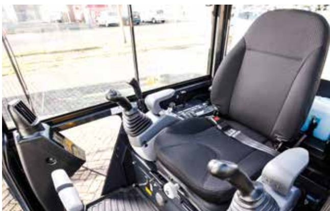
Det store høyre sidevinduet kan skyves bakover når du ønsker ekstra god sikt.
