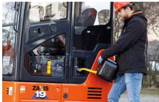
Ny plassering av åpningen til drivstofftanken gjør påfyllingen enklere.
