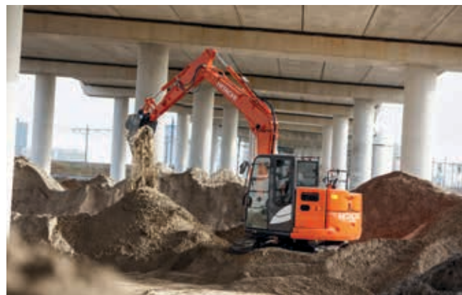
Den korte bakre svingradiusen gjør ZX85USB-6 ideell for arbeid på steder med begrenset plass.
