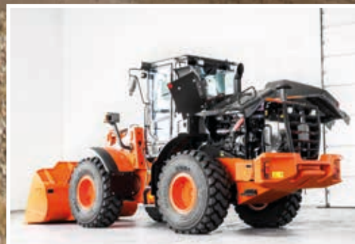
Enkel tilgang for vedlikehold fra bakkeplan.
