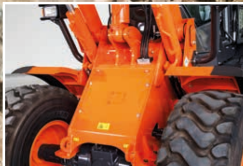
Frontrammen for ZW150-6 er blitt forsterket.
