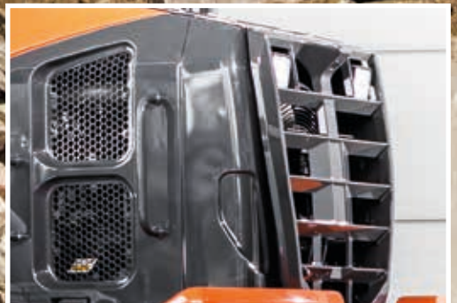
Tilstopningsfrie radiatorer øker slitestyrken.
