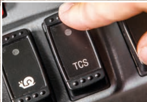
Antispinnsystemet minimerer risikoen for at hjulene glipper ved vått eller glatt underlag.
