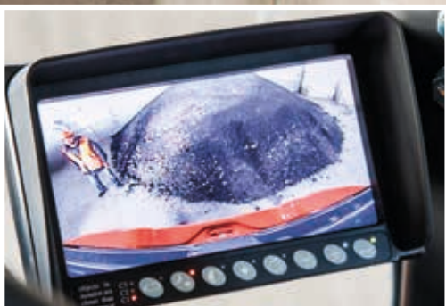
Ryggekameraet bidrar til god sikt rundt hele lasteren.
