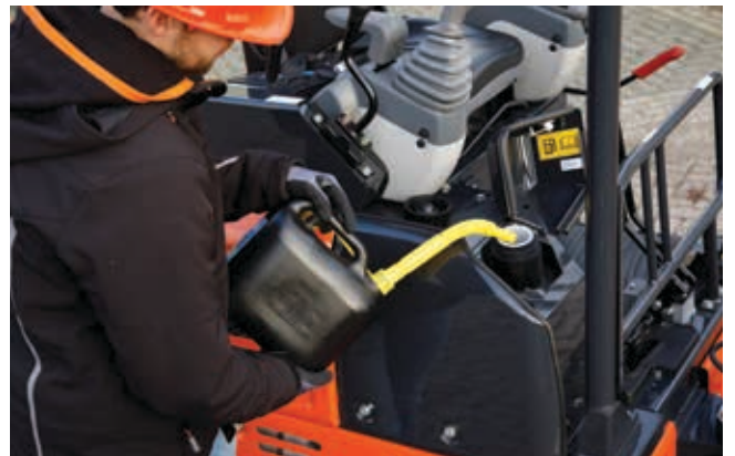
God plass rundt åpningen til drivstofftanken forenkler påfyllingen.
