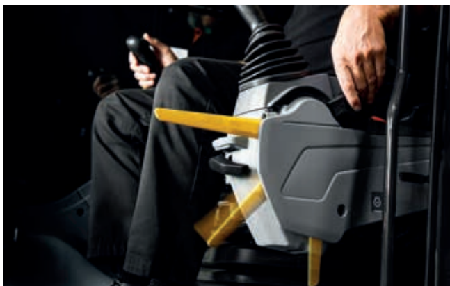
Sikkerhetsspaken for førerkontroll øker sikkerheten i førerhuset.
