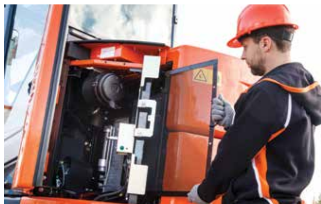
Radiatoren har støvtett nett som er lett å rengjøre.
