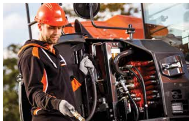
Det kan brukes en elektrisk pumpe til å fylle drivstoff på gravemaskinen.
