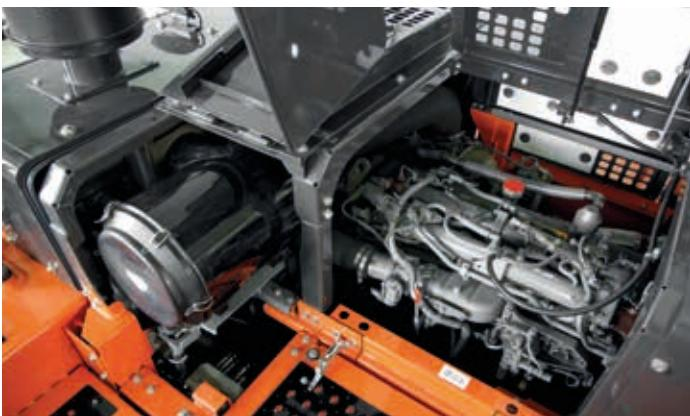
Oppgraderte motorkomponenter gir økt driftssikkerhet.
