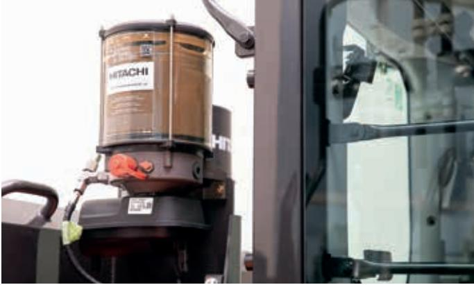
System for automatisk fettsmøring (tilleggsutstyr) sparer tid.
