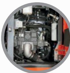
Det nye hydraulikksystemet HIOS-V reduserer drivstoffforbruket og øker hastigheten på frontutstyret, med bedre produktivitet som resultat.
