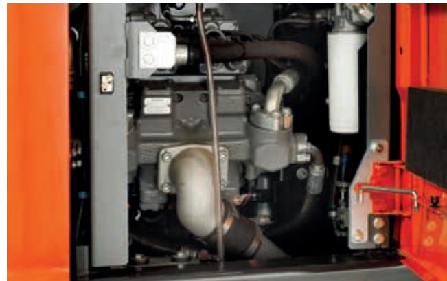
Med HIOS V-hydraulikksystemet oppnås en drivstoffbesparelse på opptil 5 % (ZX150W-7 og ZX155W-7).
