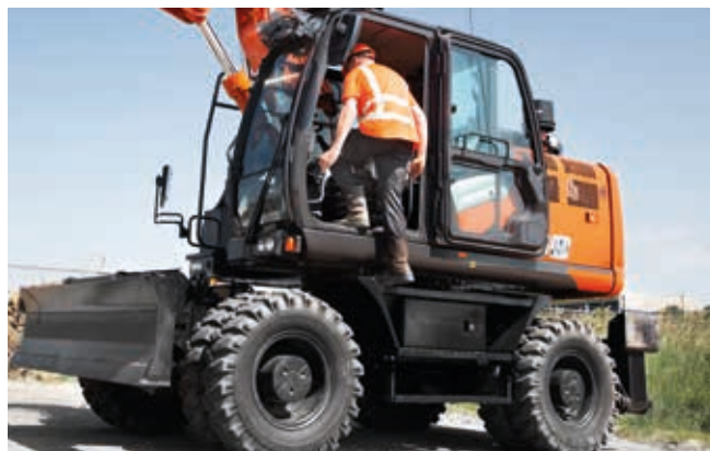
Det lave første stigtrinnet gjør tilgangen til førerhuset sikrere og enklere.
