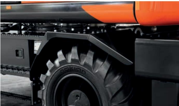
Skjermer på understellet beskytter overvognen og lysene mot skitt og holder maskinen ren.
