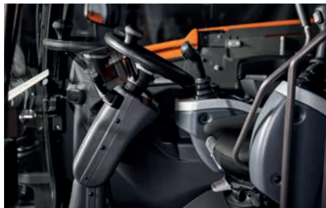
Skap den ideelle arbeidsplassen med den justerbare rattstammen.
