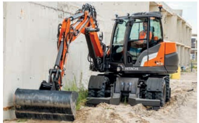
Arbeid effektivt på trange steder takket være kort svingradius og svingbom.
