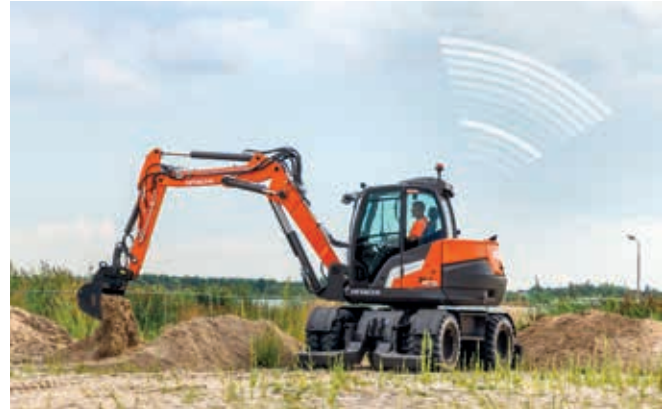
Driftsdata overføres fra maskinen via GPRS eller satellitt.
