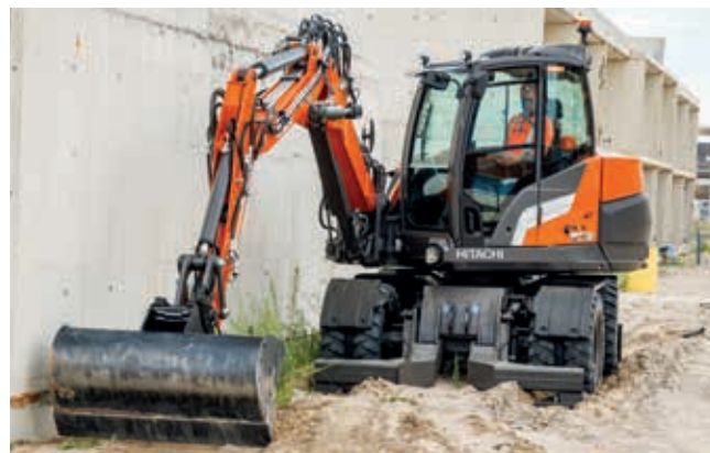
Arbeid effektivt på trange steder takket være kort svingradius og svingbom.
