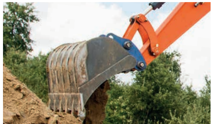
Anleggsutstyret av høy kvalitet inkluderer selvskjerpende tenner og solide adaptore, slik at alt passer perfekt.
