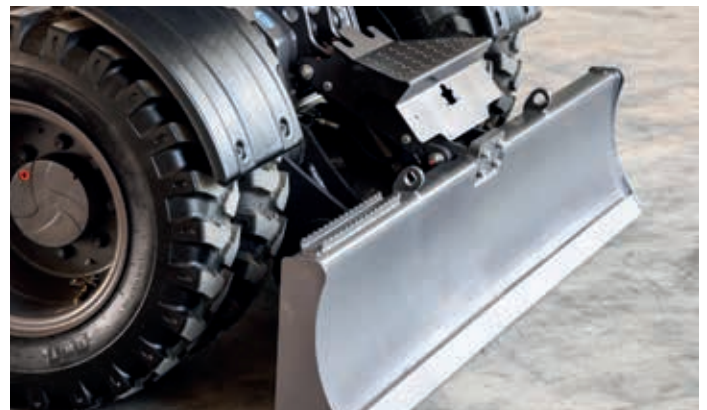
En praktisk detalj er at skjæret er forberedt for montering av tilhengerfeste.
