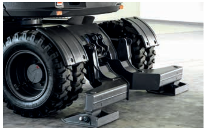
De uavhengig betjente støttebena gir bedre stabilitet.
