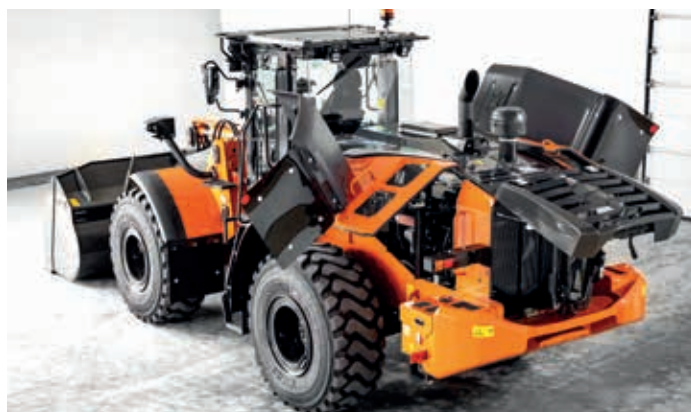
Motordekselet gir enkel tilgang for daglige inspeksjoner.
