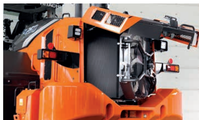
Intelligent kjøleviftesystem forhindrer tilstopping av radiatorene.
