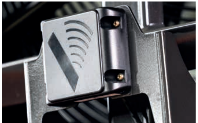
Ryggesensoren registrerer hindringer bak maskinene og gir økt sikkerhet på arbeidsplassen.
