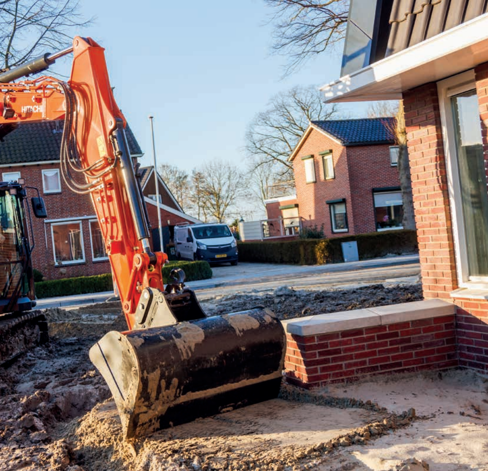
Kort avstand mellom skuffe og skjær øker effektiviteten og sikkerheten.
