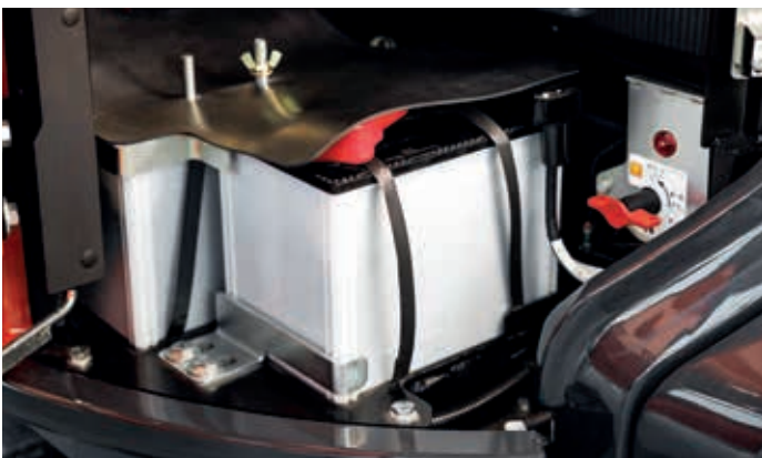
Batteriet er enklere å skifte ut.
